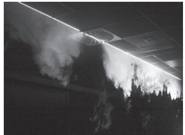
Рис. VVKN-B-K, картина распределения воздуха
